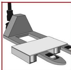
*Palettenkufen sollten grundsätzlich nur mit Hebeegeräten (Hubwagen, Gabelstapler etc.) bewegt werden. das Schieben - insbesondere auf stoppendem Untergrund - ist zu vermeiden.*
