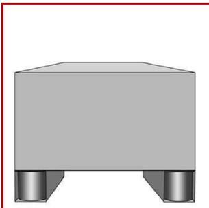
Beim Anbringen von Palettenkufen ist unbedingt auf eine hohe Standfestigkeit der Versandeinheit zu achten. Im Bereich der senkrechten Kartonwände befindet sich die größte Tragkraft. Deshalb sollten die Kufen möglichst bündig zur Außenwand positioniert werden.
