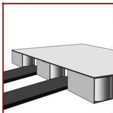
*Die Palettenkufe kann mit jedem Hubwagen und Gabelstapler befördert werden. Die Gabeln sollten exakt in die vorhergesehenen Unterfahrungsbereiche eingeführt werden. So wird eine Beschädigung der Kufe vermieden.*
